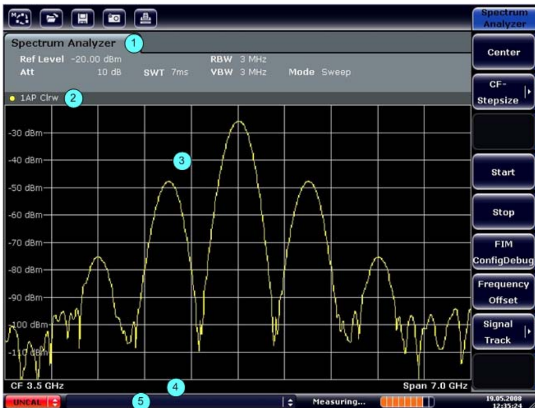
图 4-1: 分析仪操作过程中 R&S FSV 的屏幕布局
