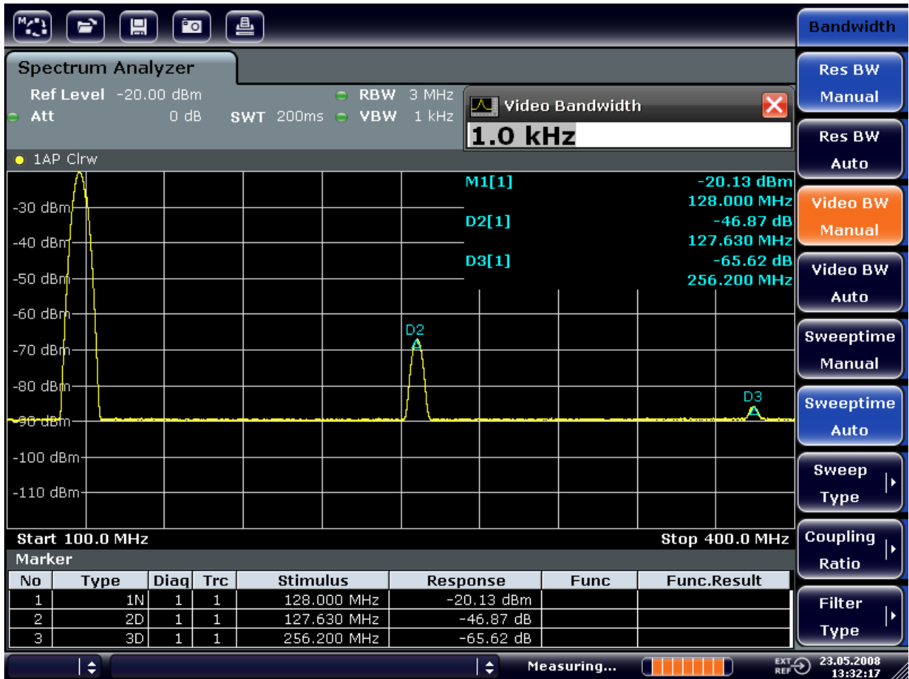
图 5-3：在谐波测量过程中，通过降低视频带宽抑制噪声
