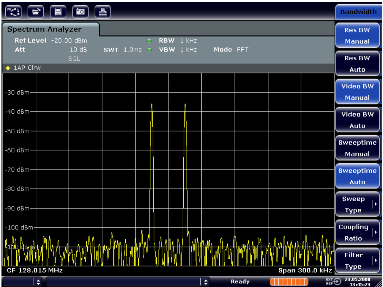
图 5-6: 测量两个等电平的射频正弦信号，分辨率带宽（1 kHz）明显小于信号的频率间隔
