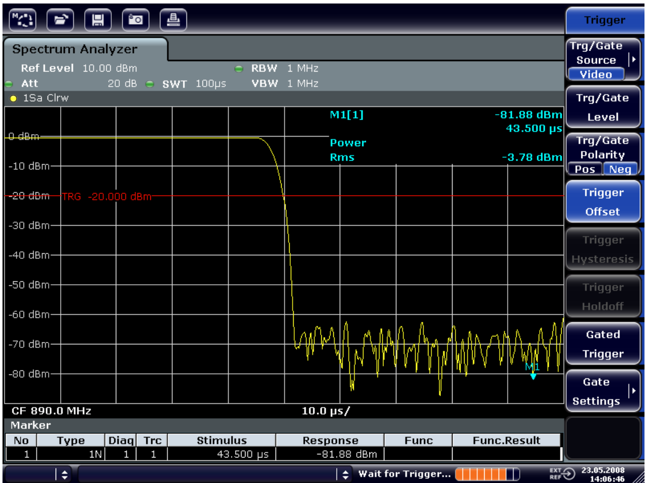
图 5-11: 高时间分辨率下显示的 GSM 突发信号的下降沿
