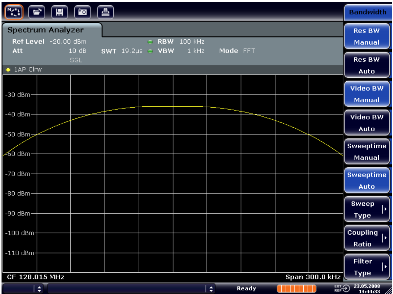
图 5-5: 测量两个等电平的射频正弦信号，分辨率带宽大于信号的频率间隔
